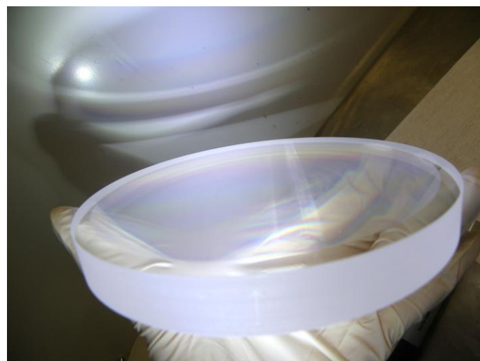
D136mm Grating on a D150mm Suprasil Substrate
